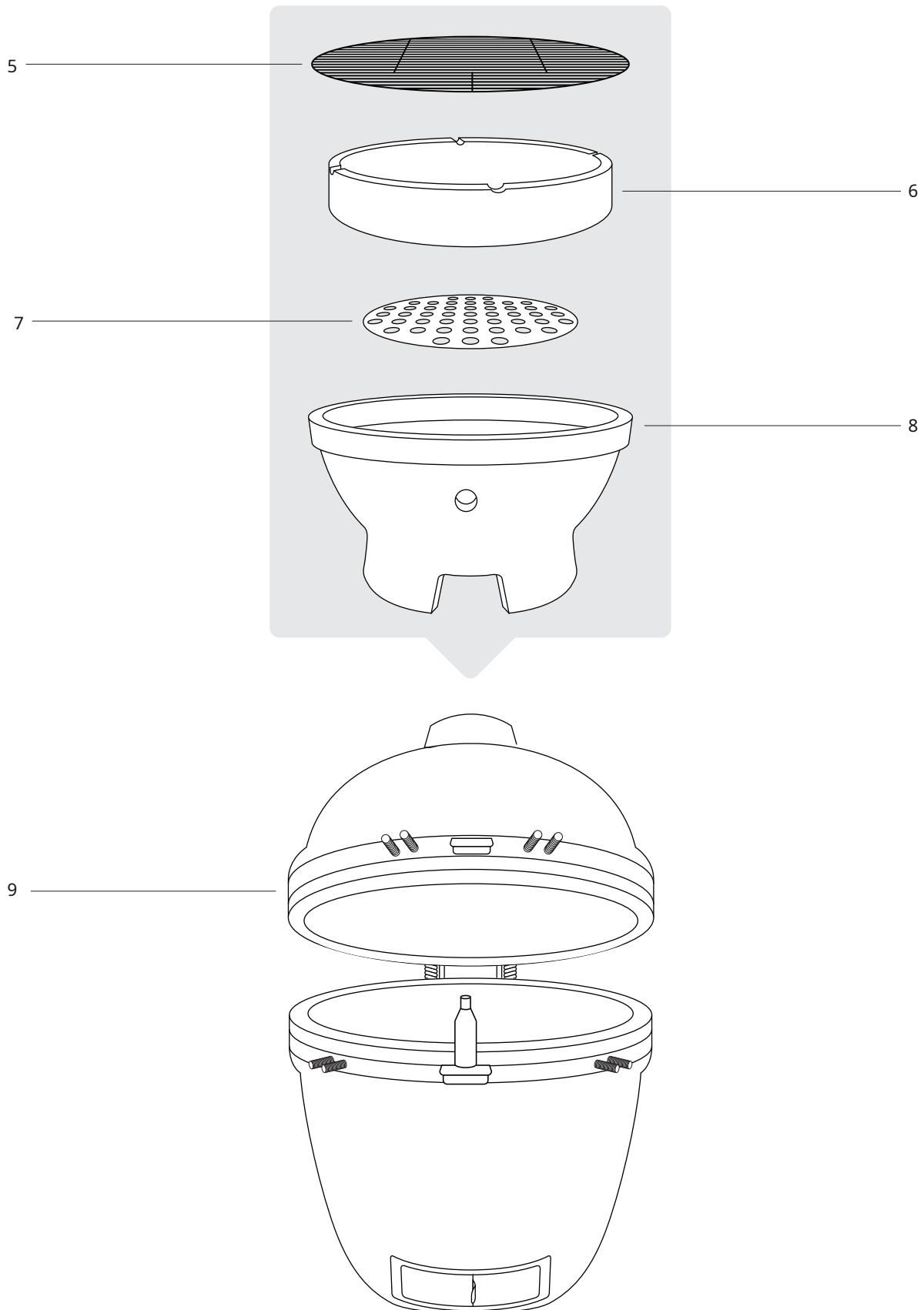
**KROK 8** -Když je gril bezpečně umístěn na vozíku, přidejte toopeniště (8), desku na dřevěné uhlí (7), horní kroužek (6) a grilovací gril (5) uvnitř grilu Kamado, jak je znázorněno na montážním schématu.
