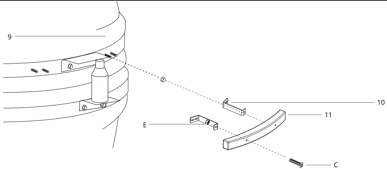
**STAP 10 -** Om de handgreep (10) aan het deksel van de KamadoGrill (9) te bevestigen, begint u met het bevestigen van 2 x handgreepbeugels (11) met behulp van de 2 vooraf bevestigde bouten en bokkopmoeren. Bevestig de handgreep (11) aan de beugels (10) met behulp van 2 bouten (C) en moeren (E).
