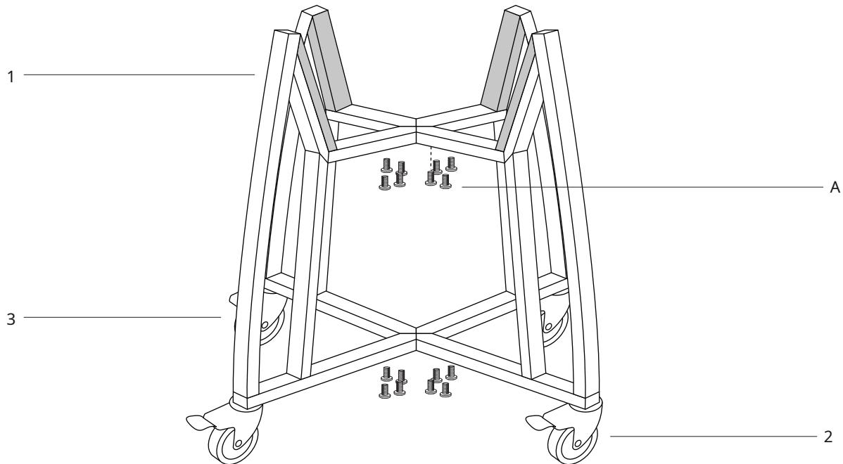
**PASSO 4** -Fixe os suportes (1) nas travessas (4) usando os parafusos 16x (A). Certifique-se de que o carrinho esteja seguro e todos os parafusos estão apertados antes de colocar a Grelha Kamado (9) nela.
