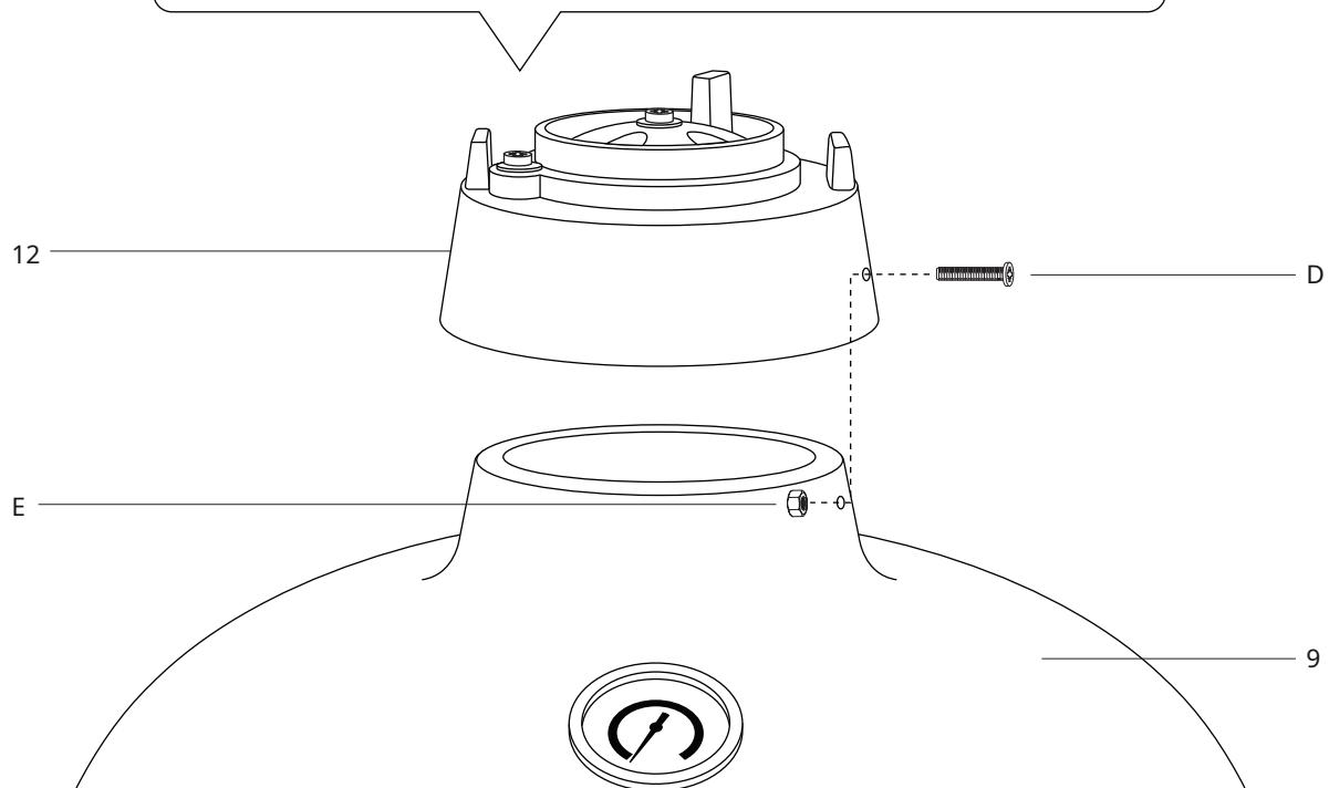
**ÉTAPE 11 -**Pour fixer l'évent supérieur (12) au Kamado Grill (9), placez-le sur le dessus et alignez les deux trous de boulons. Sécurisé à l'aide de 2x boulons (D) et écrous (E). Assurez-vous que le boulon de ventilation supérieur se trouve sur le côté gauche lors de son assemblage.
