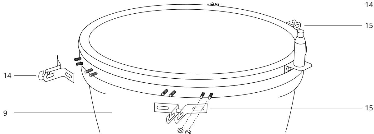
**VAIHE 12 -** Kiinnitä 2x pöytäkiinnike (14) Kamado Grilliin (9) käyttämällä 4x valmiiksi kiinnitettyjä pultteja ja kupupäisiä muttereita kiinnikettä kohti. Huomaa yllä olevassa kaaviossa näkyvä sijainti
