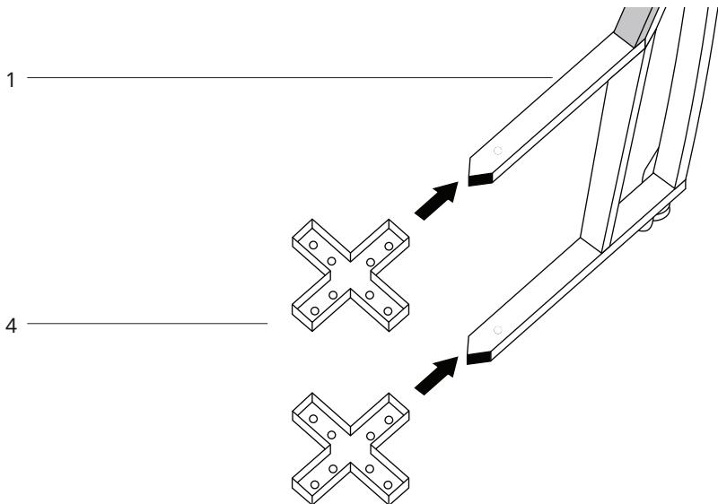
**PASSO 2** -Para montar o carrinho insira as duas travessas (4) em um dos quatro suportes (1) tanto pela parte superior quanto fundo.
