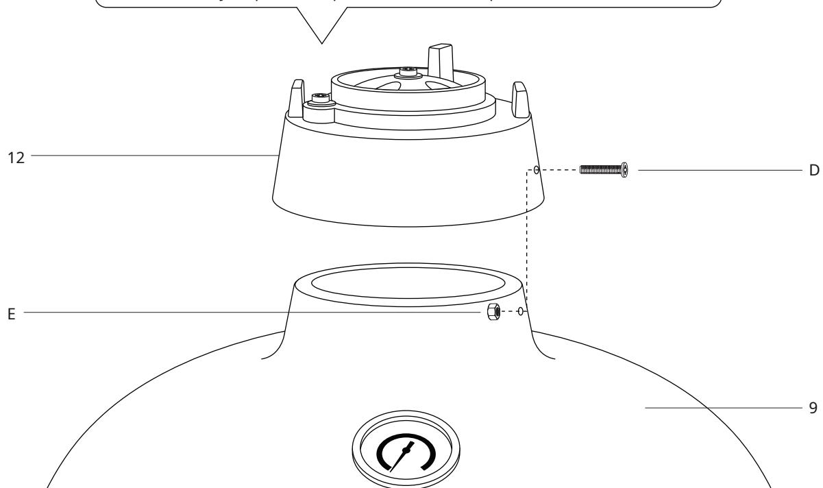
**VAIHE 11 -**Kiinnitä ylempi tuuletusaukko (12) Kamado Grilliin (9) asettamalla se päälle ja kohdistamalla molemmat pultinreiät. Turvallinen käyttämällä 2x pultteja (D) ja muttereita (E). Varmista, että ylempi tuuletuspultti on vasemmalla puolella, kun kokoat sitä.
