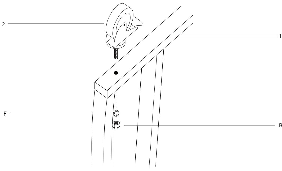
**STEG 1** -Fäst de fyra förgängade länkhjulen (2 & 3) på var och en av de fyra fästena (1) genom att trycka på dem genom hålet. Använd en justerbar skiftnyckel och fäst varje länkhjul med 1x mutter (B).
