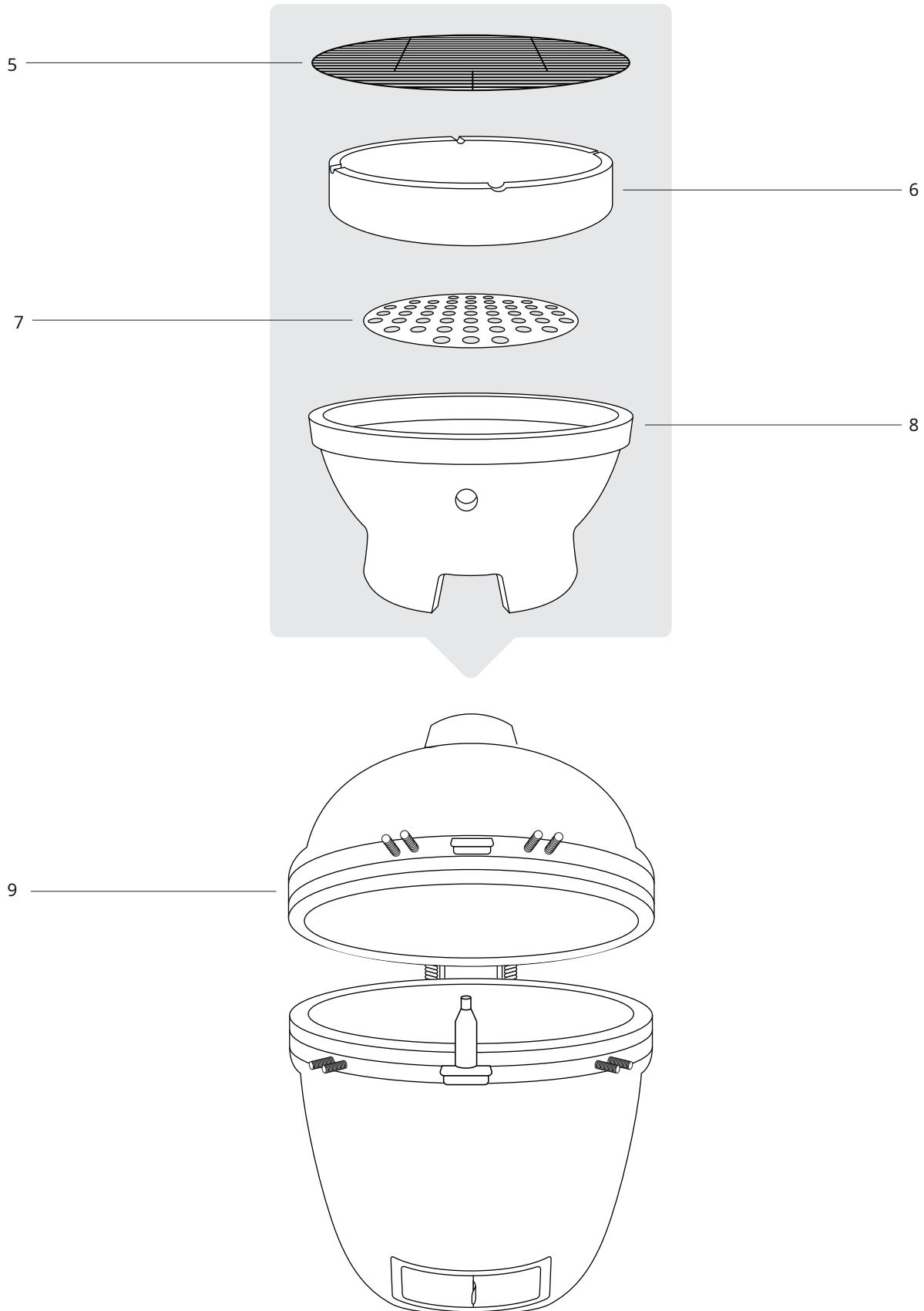
**PASSO 8** -Quando a grelha estiver bem colocada no carrinho, adicione a fornalha (8), a placa de carvão (7), o anel superior (6) e grelha de cozimento (5) dentro da churrasqueira Kamado conforme exibido no diagrama de montagem.
