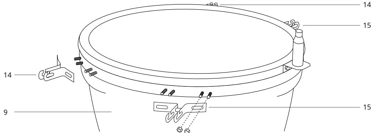
**ÉTAPE 12 -** Fixez les 2 supports de table (14) au Kamado Grill (9) à l'aide des 4 boulons pré-fixés et des écrous à tête bombée par support. Veuillez noter la position indiquée dans le schéma ci-dessus
