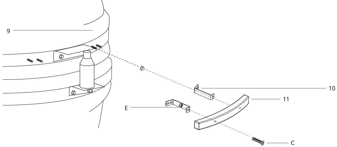
**STEG 10 -** För att fästa handtaget (10) på locket på KamadoGrill (9) börjar du med att fästa 2xhandtagsfästen (11) med de 2xförmonterade bultarna och kupolmuttrarna. Fäst handtaget (11) på fästena (10) med 2xbultar (C) och muttrar (E).
