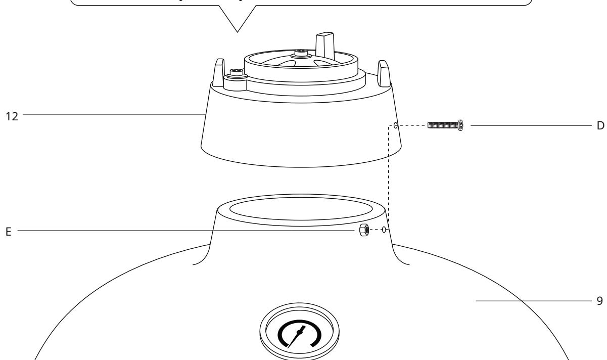
**KROK 11 -** Chcete-li připevnit horní větrací otvor (12) ke grilu Kamado (9), umístěte jej nahoru a zarovnejte oba otvory pro šrouby. Zajistit pomocí 2x šroubů (D) a matic (E). Při montáži se ujistěte, že je horní odvzdušňovací šroub na levé straně.
