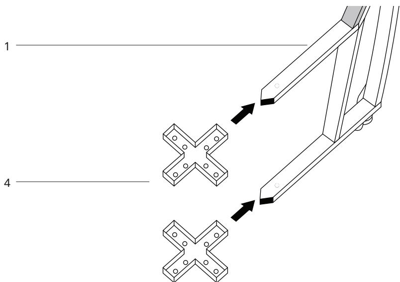
**PASSO 2** -Per montare il carrello inserire le due traverse (4) in una delle quattro staffe (1) sia dall'alto che
