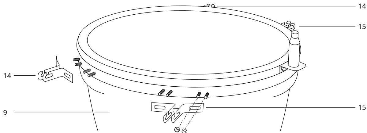
**KROK 12 -** Připevněte 2x držák stolu (14) ke grilu Kamado (9) pomocí 4x předem připevněných šroubů a matic s kupolovou hlavou na držák. Všimněte si polohy znázorněné na obrázku výše
