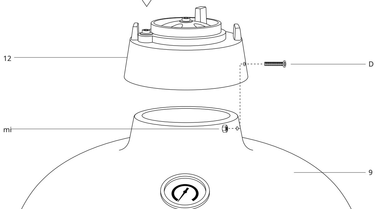
**KROK 11 -**Aby przymocować górny otwór wentylacyjny (12) do grilla Kamado (9), umieść go na górze i zrównaj oba otwory na śruby. Bezpieczne za pomocą 2 śrub (D) i nakrętek (E). Podczas montażu upewnij się, że góra śruba odpowietrzająca znajduje się po lewej stronie.
