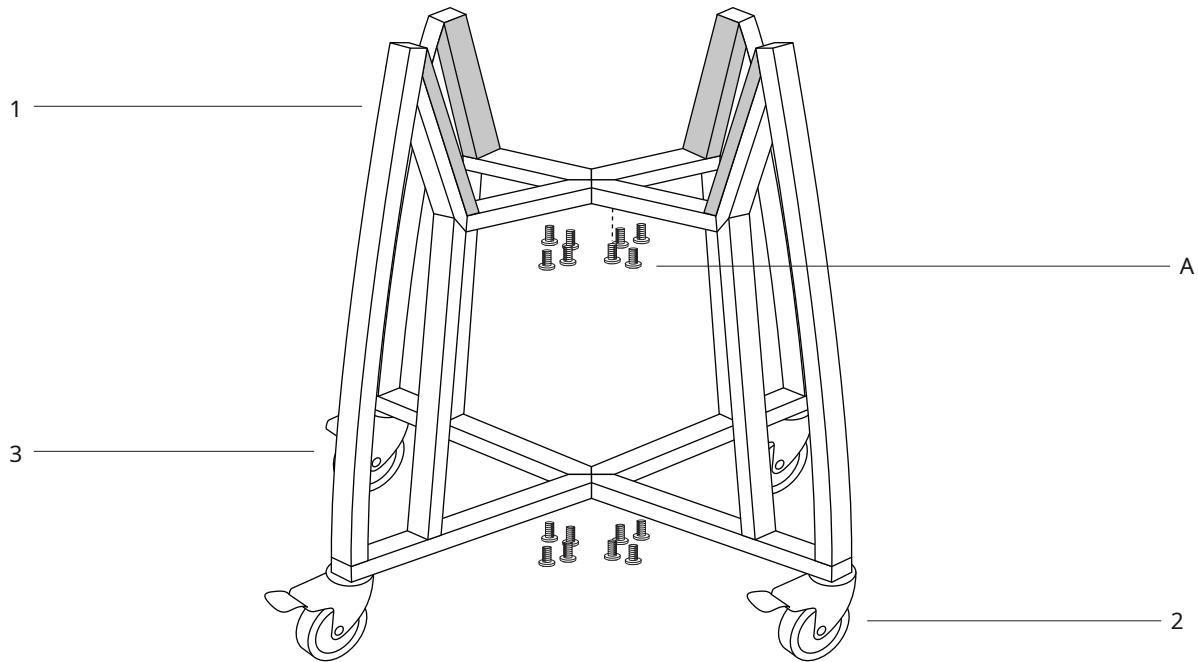
**KROK 4** -Przymocuj wsporniki (1) do elementów poprzecznych (4) za pomocą 16 śrub (A). Upewnij się, że wózek jest bezpieczny i dokrć wszystkie śruby przed umieszczeniem w nim grilla Kamado (9).
