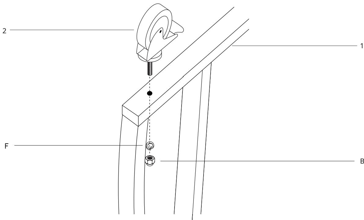
**KORAK 1** -Pričvrstite četiri kotačića s prethodno navojem (2 i 3) na svaki od četiri nosača (1) gurajući ih kroz rupu. Pomoću podesivog ključa pričvrstite svaki kotačić s 1x maticom (B).
