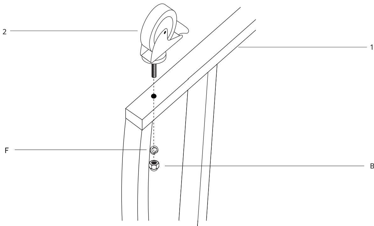
**TRINN 1** -Fest de fire forhåndsgjengede styrehjulene (2 og 3) til hver av de fire brakettene (1) ved å skyve dem gjennom hullet. Bruk en justerbar skiftenøkkel og fest hvert styrehjul med 1x mutter (B).
