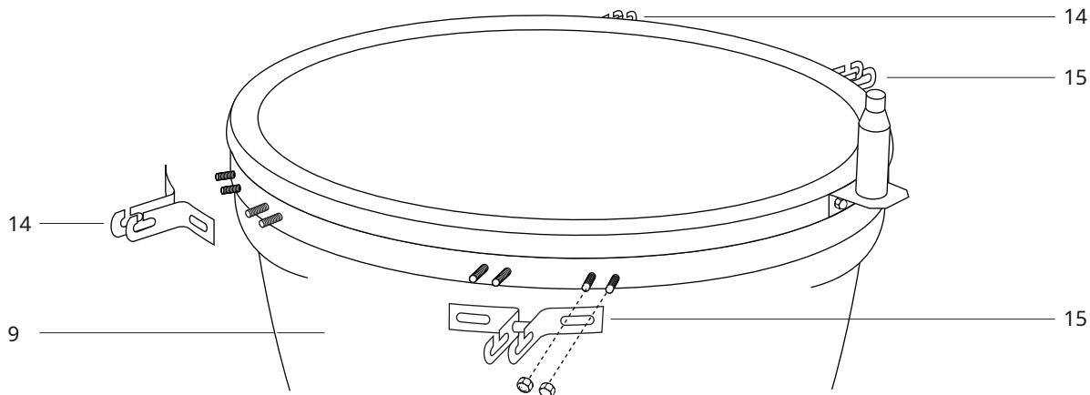
**PASSO 12 -** Fixe os 2 suportes de mesa (14) à churrasqueira Kamado (9) usando os 4 parafusos pré-fixados e porcas de cabeça abaulada por suporte. Observe a posição mostrada no diagrama acima
