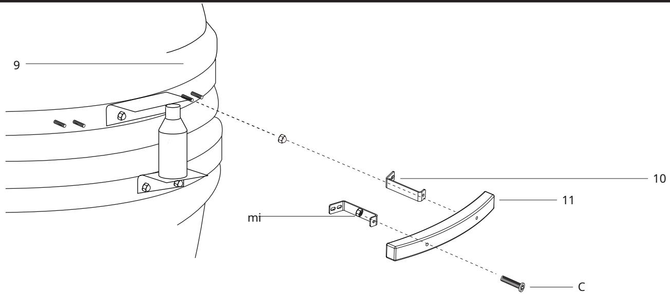
**KROK 10 -** Aby przymocować uchwyt (10) do pokrywy grilla Kamado (9), zaczni od przymocowania 2 wsporników uchwytu (11) za pomocą 2 wstępnie przymocowanych śrub i nakrętek kopułkowych. Przymocuj uchwyt (11) do wsporników (10) za pomocą 2 śrub (C) i nakrętek (E).
