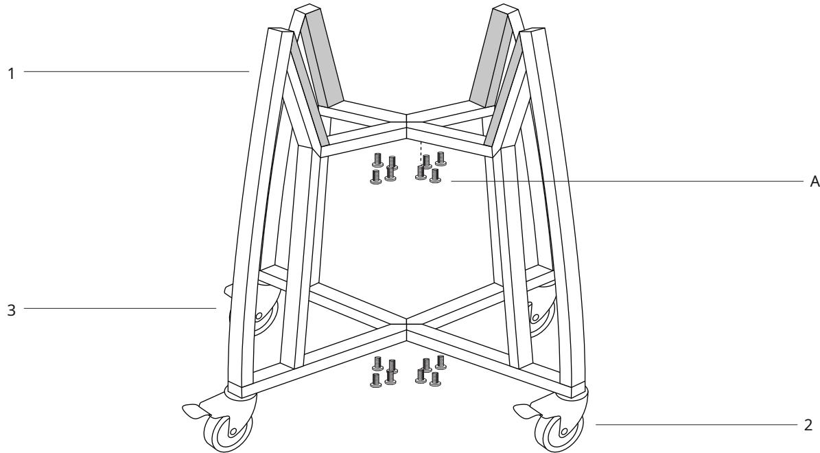
**KROK 4** -Připevněte držáky (1) k příčným dílům (4) pomocí 16x šroubů (A). Ujistěte se, že je vozík zajištěn a všechny šrouby jsou utažené, než do něj umístíte gril Kamado (9).
