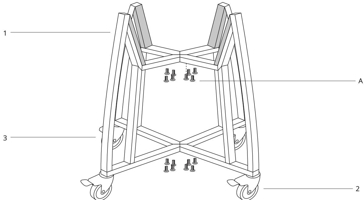
**STAP 4** -Bevestig de beugels (1) aan de dwarsstukken (4) met behulp van de 16x schroeven (A). Zorg ervoor dat de kar veilig is en alle schroeven goed vastzitten voordat u de Kamado Grill (9) erin plaatst.
