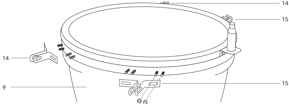
**KORAK 12 -** Pričvrstite 2x nosača stola (14) na Kamado roštilj (9) pomoću 4x prethodno pričvršćenih vijaka i matica s kupolastom glavom po nosaču. Obratite pažnju na položaj prikazan na gornjem dijagramu
