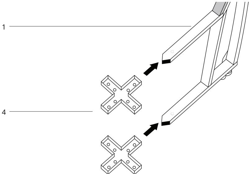
**2. LÉPÉS** -A kocsi összeszereléséhez helyezze be a két keresztdarabot (4) a négy konzol (1) egyikébe felülről és alsó.
