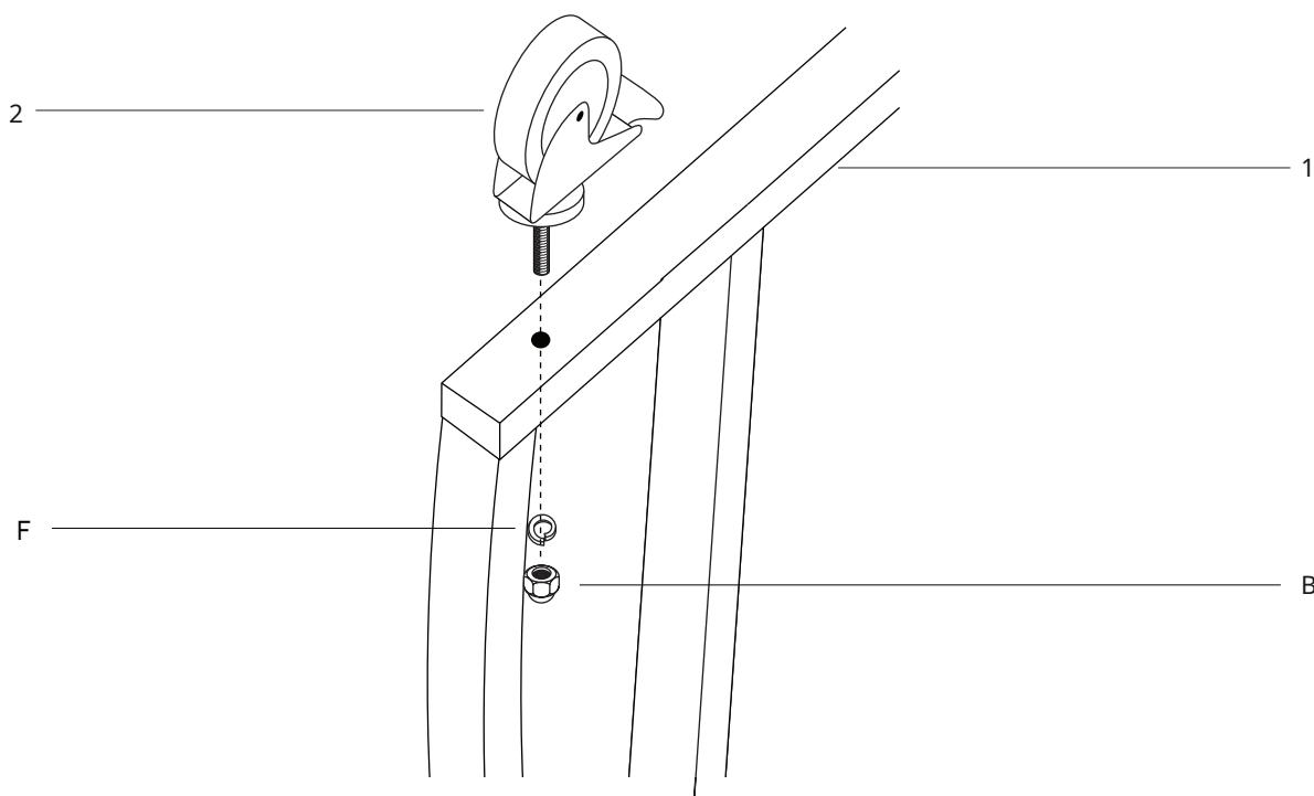
**STAP 1** -Bevestig de vier zwenkwielden met schroefdraad (2 en 3) aan elk van de vier beugels (1) door erop te duwen door het gat. Gebruik een verstelbare sleutel om elk zwenkwiel vast te zetten met 1x moer (B).
