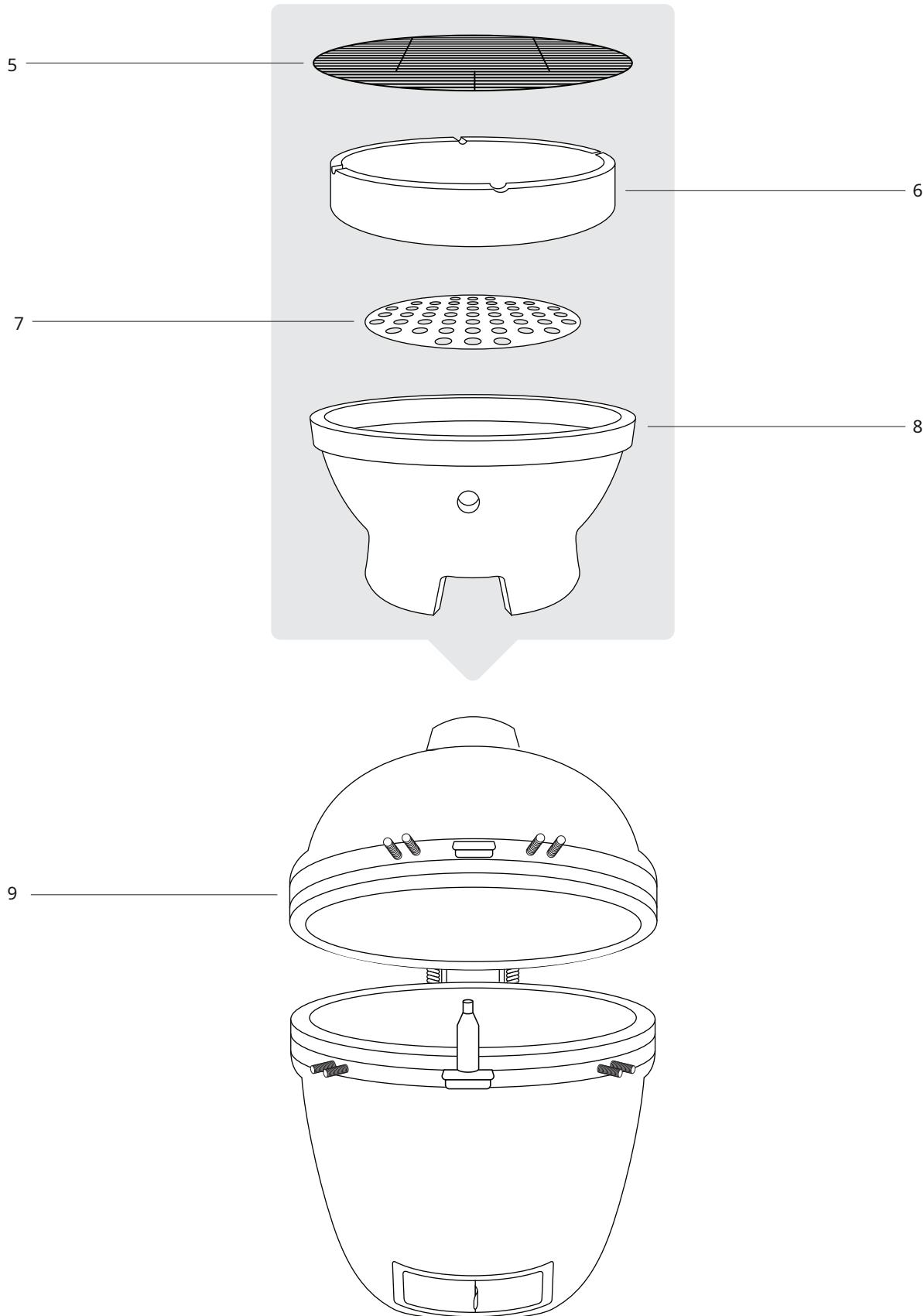
**KROK 8** -Keď je gril bezpečne umiestnený na vozíku, pridajte ohnisko (8), platňu na drevené uhlie (7), horný krúžok (6) a gril na varenie (5) vo vnútri grilu Kamado, ako je znázornené na montážnom diagrame.
