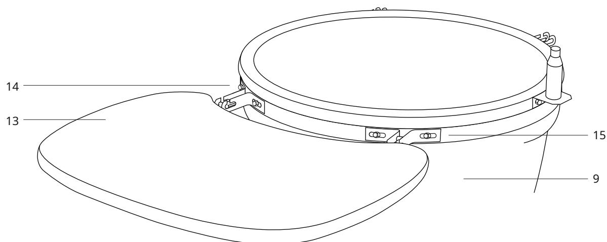
**STEG 14 -** Sätt in 2x bordsgångjärnet i var och en av bordsfästena (14 & 15).
