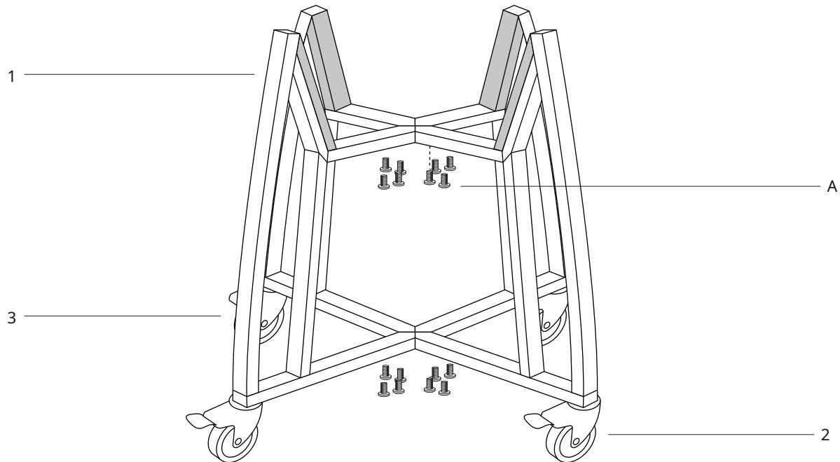
**STEG 4** -Fäst fästena (1) vid tvärstyckena (4) med hjälp av de 16x skruvorna (A). Se till att vagnen är säker och alla skruvar är åtdragna innan du placerar Kamado Grill (9) i den.
