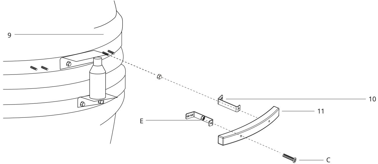
**PASSO 10-** Per fissare la maniglia (10) al coperchio del Kamado Grill (9), iniziare collegando 2 staffe della maniglia (11) utilizzando i 2 bulloni premontati e i dadi a testa tonda. Fissare la maniglia (11) alle staffe (10) utilizzando 2 bulloni (C) e dadi (E).
