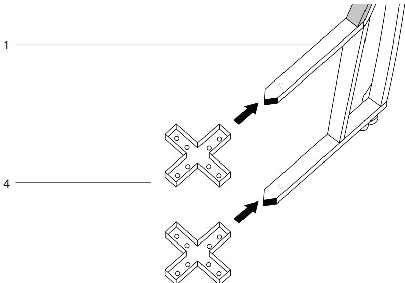
**ÉTAPE 2** -Pour assembler le chariot, insérez les deux traverses (4) dans l'un des quatre supports (1) depuis le haut et bas.
