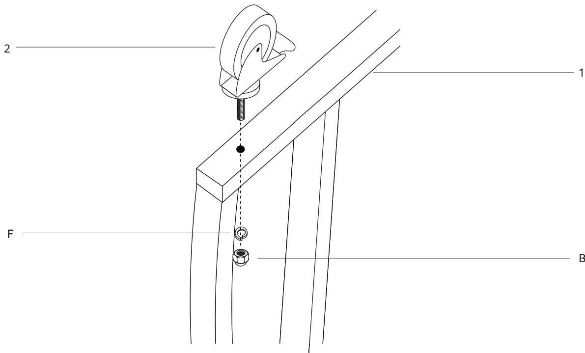
**KROK 1** -Prievnrite štyri predzávitové kolieska (2 a 3) ku každej zo štyroch konzol (1) tak, že ich zatlačíte cez dieru. Pomocou nastaviteľného klúča zaistite každé koliesko 1x maticou (B).
