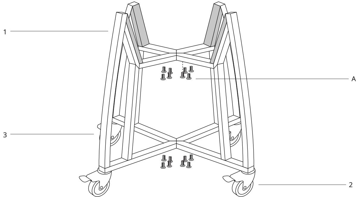
**VAIHE 4** -Kiinnitä kannattimet (1) poikkikappaleisiin (4) käyttämällä 16x ruuveja (A). Varmista, että kärry on turvallinen ja kaikki ruuvit on kiristetty ennen kuin asetat Kamado Grillin (9) siihen.
