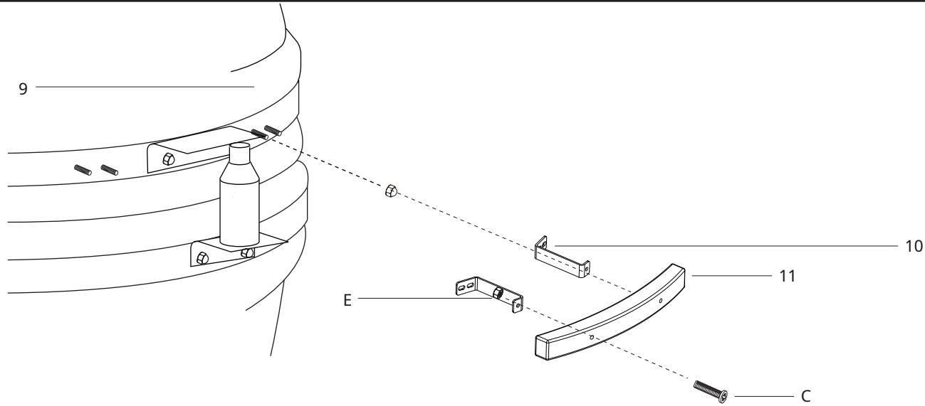
**KORAK 10 -** Za pričvršćivanje ručke (10) na poklopac KamadoGrill-a (9) započnite pričvršćivanjem 2x nosača ručke (11) pomoću 2x vijka i matica s kupolastom glavom. Pričvrstite ručku (11) na nosače (10) pomoću 2 vijka (C) i matica (E).
