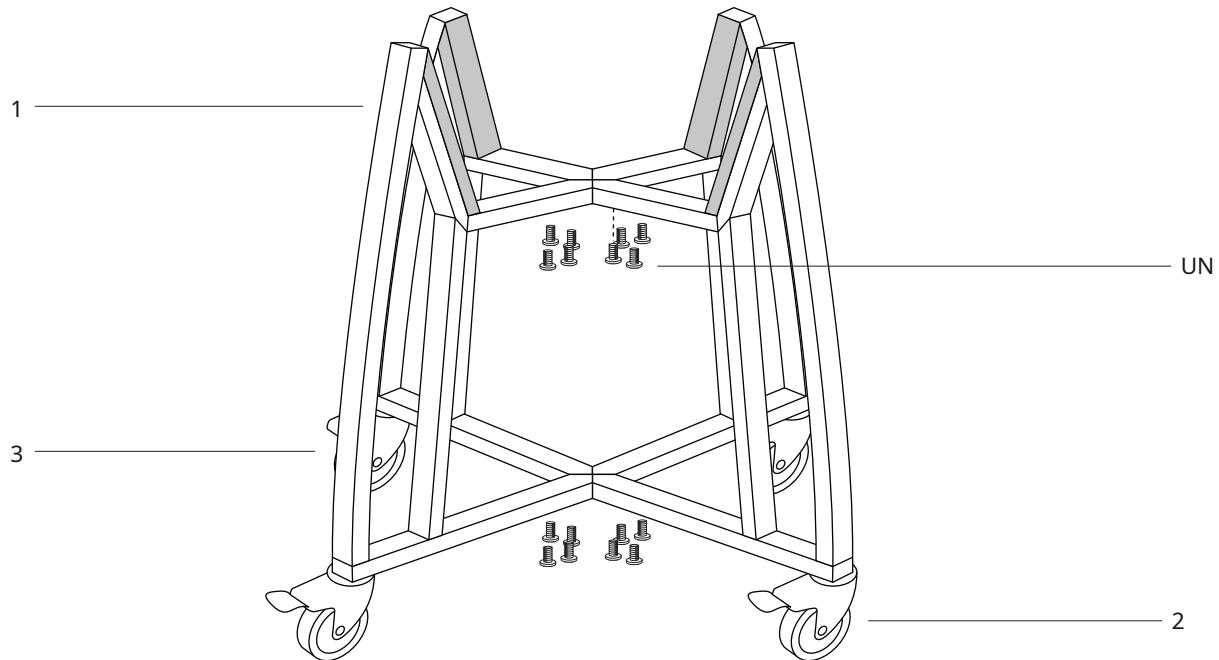
**PASSO 4** -Fissare le staffe (1) alle traverse (4) utilizzando le 16 viti (A). Assicurati che il carrello sia sicuro e tutte le viti siano serrate prima di inserire il Kamado Grill (9).
