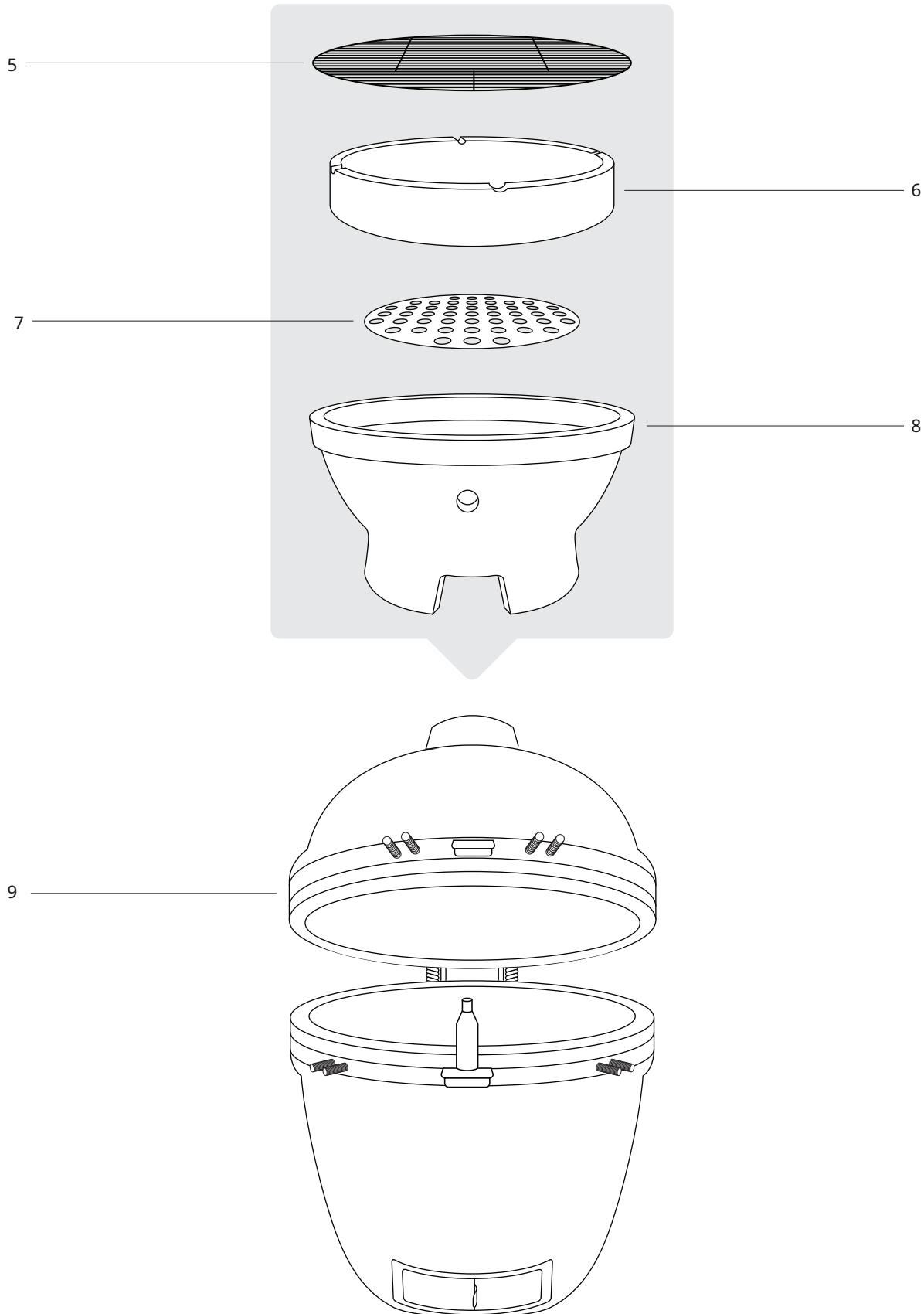
**SCHRITT 8** -Wenn der Grill sicher auf dem Wagen platziert ist, fügen Sie den Feuerraum (8), die Holzkohleplatte (7), den oberen Ring (6) usw. hinzu
