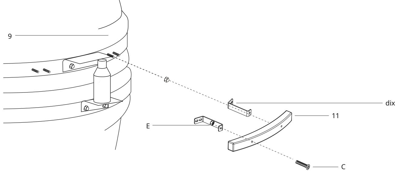
**ÉTAPE 10 -** Pour fixer la poignée (10) au couvercle du KamadoGrill (9), commencez par fixer 2 supports de poignée (11) à l'aide des 2 boulons et écrous à tête bombée pré-fixés. Fixez la poignée (11) aux supports (10) à l'aide de 2 boulons (C) et écrous (E).
