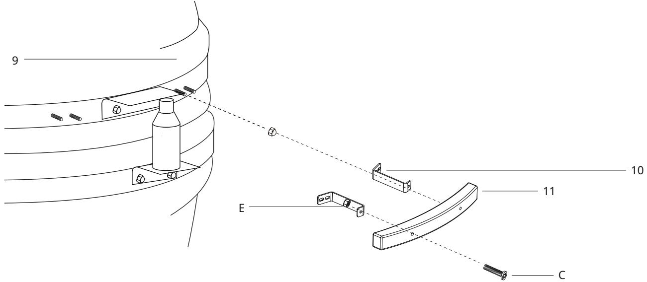
**TRINN 10 -** For å feste håndtaket (10) til lokket på KamadoGrillen (9) begynner du med å feste 2x håndtaksbraketter (11) ved å bruke de 2x forhåndsmonterte boltene og kuppelmutrene. Fest håndtaket (11) til brakettene (10) med 2xbolter (C) og mutre (E).
