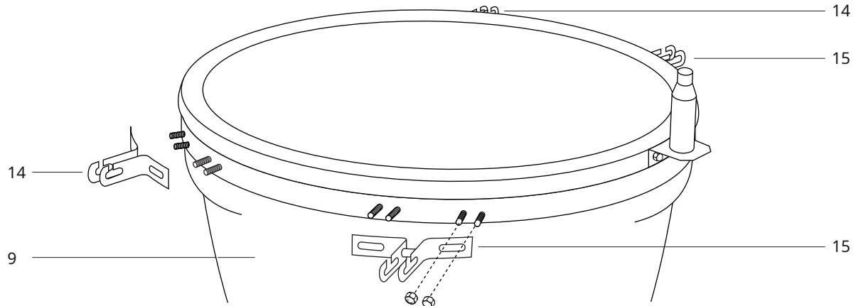
**STAP 12 -** Bevestig de 2x tafelbeugels (14) aan de Kamado Grill (9) met behulp van de 4x vooraf bevestigde bouten en bokkopmoeren per beugel. Let op de positie weergegeven in het bovenstaande diagram
