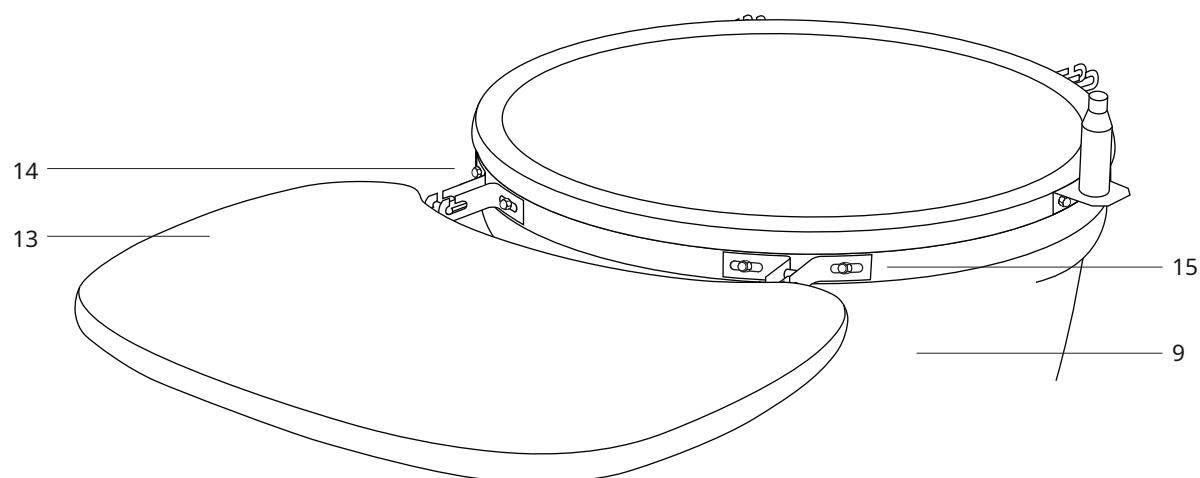
**SCHRITT 14 -** Setzen Sie die 2x Tischscharniere in jede der Tischhalterungen (14 und 15) ein.
