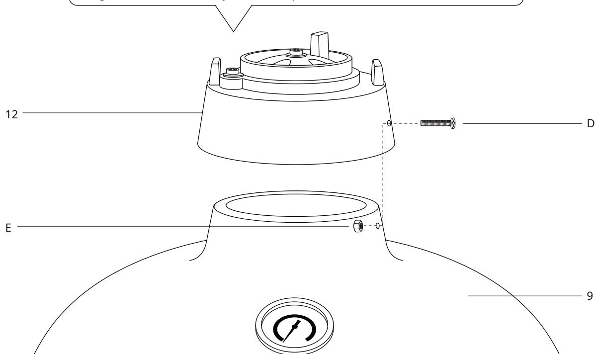
**TRINN 11 -** For å feste den øvre ventilen (12) til Kamado Grill (9), plasser den på toppen og juster begge boltehullene. Sikre ved hjelp av 2x bolter (D) og muttere (E). Sørg for at den øvre ventilasjonsbolten er på venstre side når du monterer den.
