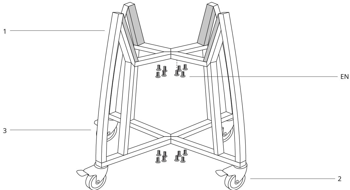
**TRINN 4** -Fest brakettene (1) til tverrstykke (4) ved å bruke 16x skruene (A). Sørg for at vognen er sikker og alle skruene er stramme før du plasserer Kamado Grill (9) i den.
