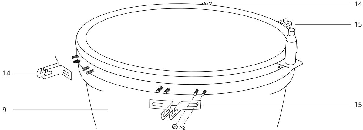
**TRIN 12 -** Fastgør 2x bordbeslagene (14) til Kamado Grillen (9) ved hjælp af de 4x forudmonterede bolte og kuppelmøtrikker pr. beslag. Bemærk venligst positionen vist i ovenstående diagram
