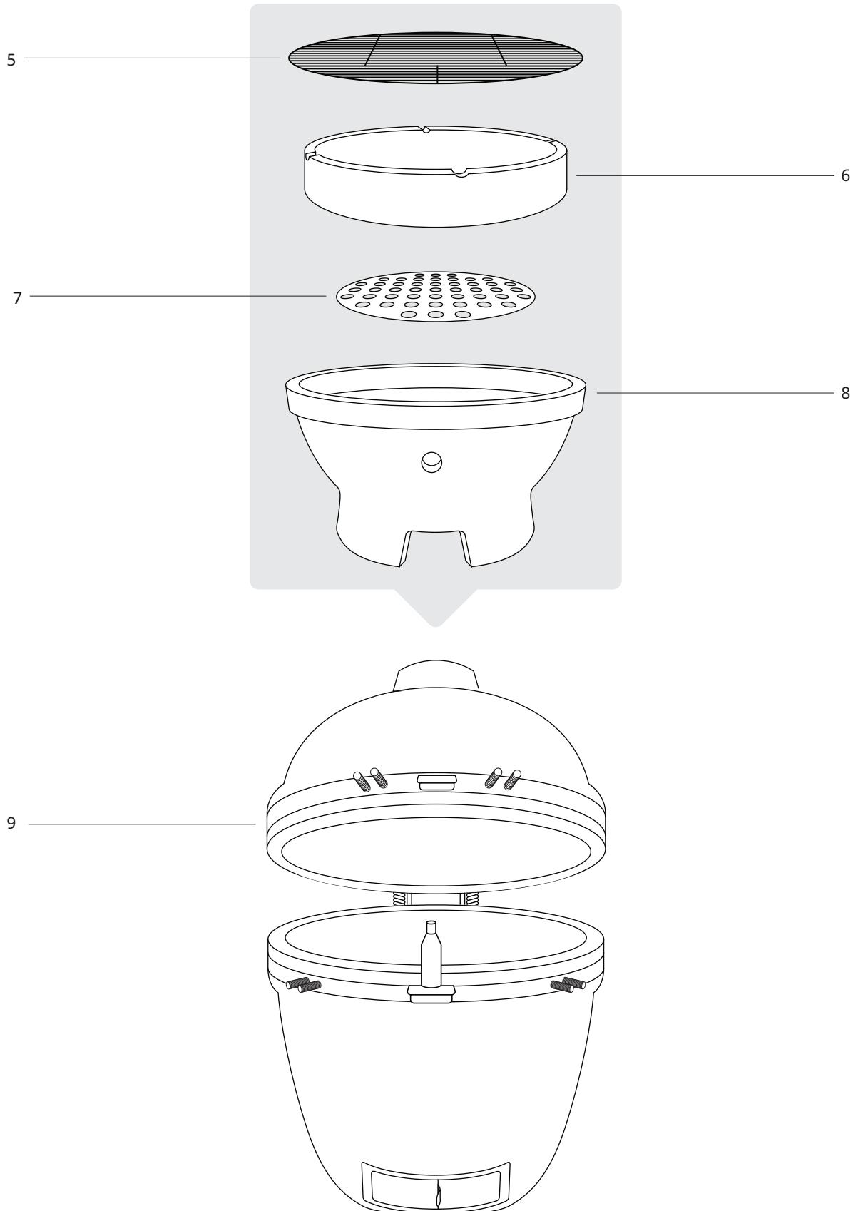
**PASO 8** -Cuando la parrilla esté colocada firmemente en el carro, agregue la cámara de combustión (8), la placa de carbón (7), el anillo superior (6) y parrilla de cocción (5) dentro de Kamado Grill como se muestra en el diagrama de montaje.
