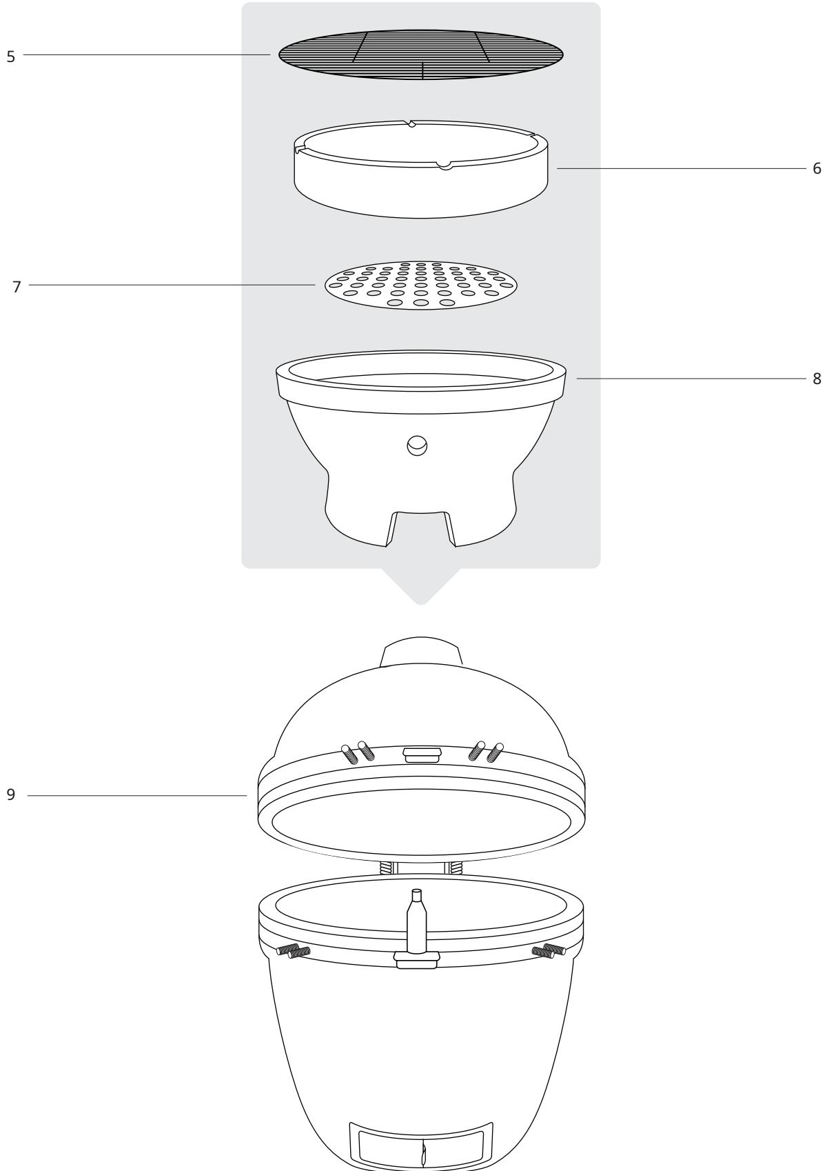
**TRINN 8** -Når grillen er sikkert plassert på vognen, legg til brennkammer (8), kullplate (7), øvre ring (6) og grill (5) på innsiden av Kamado-grillen som vist i monteringsdiagrammet.
