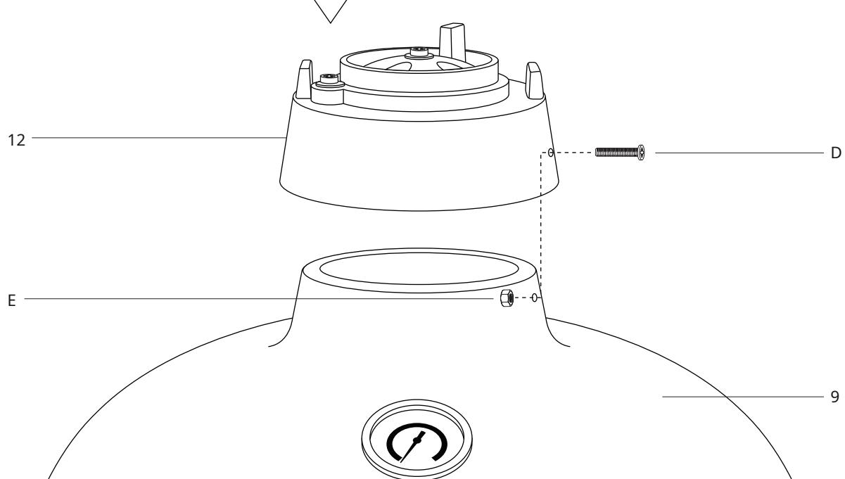
**SCHRITT 11 -** Um die obere Lüftungsöffnung (12) am Kamado-Grill (9) zu befestigen, platzieren Sie sie oben und richten Sie beide Schraubenlöcher aus. Sicher mit 2x Schrauben (D) und Muttern (E). Achten Sie beim Zusammenbau darauf, dass sich die obere Entlüftungsschraube auf der linken Seite befindet.
