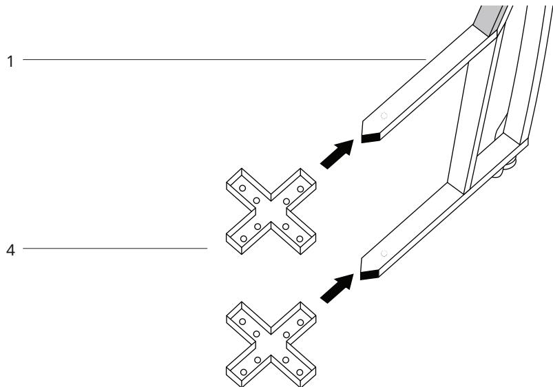
**STEG 2** -För att montera vagnen, sätt in de två tvärstyckena (4) i en av de fyra fästena (1) från båten och botten.
