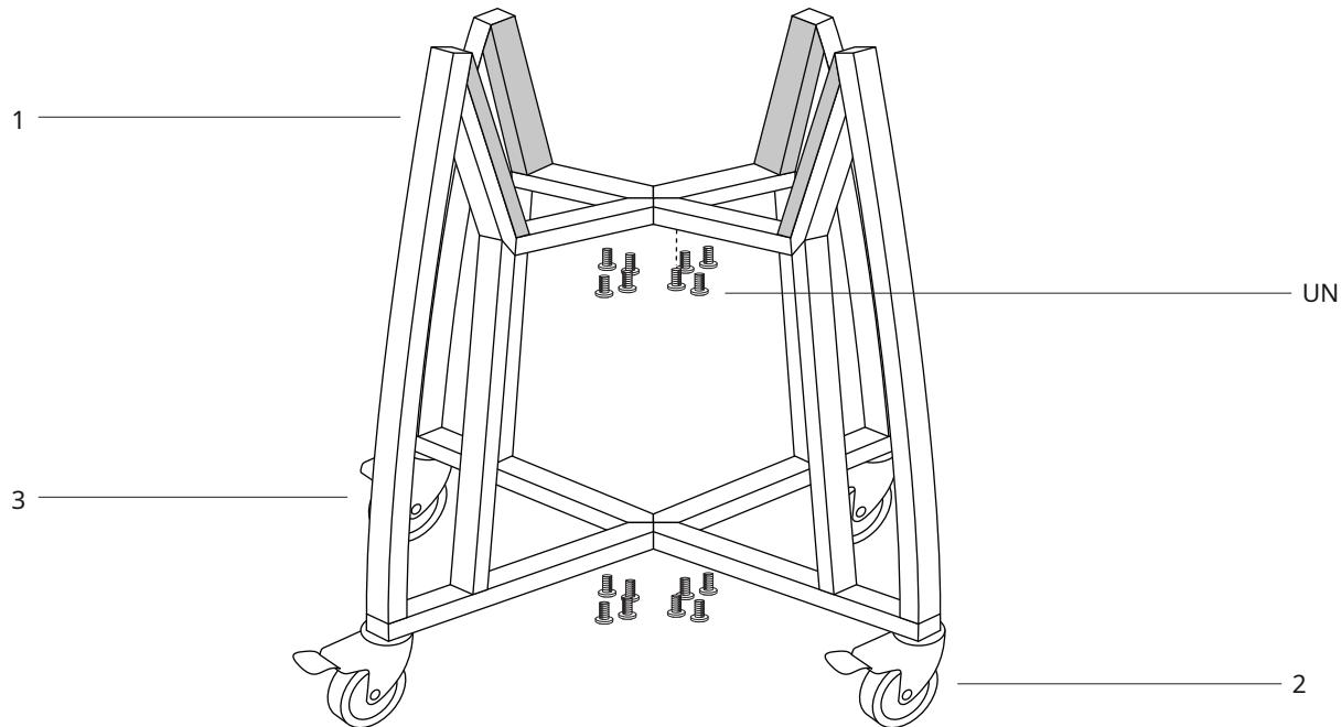
**ÉTAPE 4** -Fixez les supports (1) aux traverses (4) à l'aide des 16 vis (A). Assurez-vous que le chariot est sécurisé et toutes les vis sont bien serrées avant d'y placer le Kamado Grill (9).
