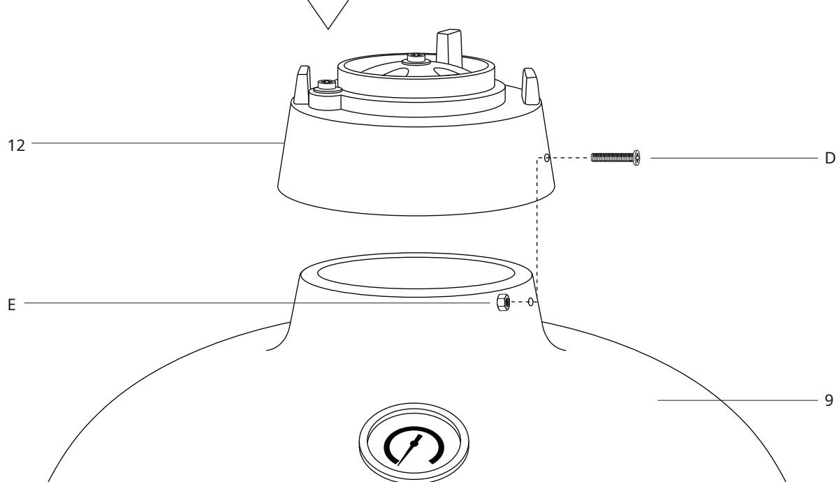
**STAP 11 -** Om de bovenste ventilatieopening (12) aan de Kamado Grill (9) te bevestigen, plaatst u deze erop en lijnt u beide boutgaten uit. Zeker met behulp van 2x bouten (D) en moeren (E). Zorg ervoor dat de bovenste ontluchtingsbout zich aan de linkerkant bevindt tijdens de montage.
