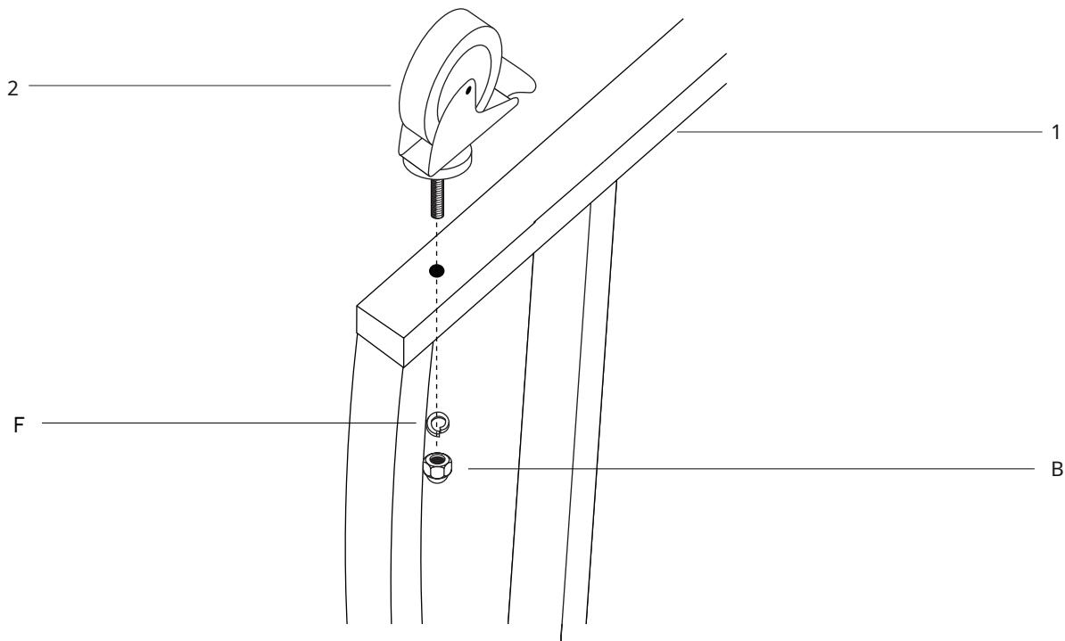
**SCHRITT 1** -Befestigen Sie die vier vorgeschaubten Lenkrollen (2 und 3) an jeder der vier Halterungen (1), indem Sie sie hineinschieben durch das Loch. Befestigen Sie jedes Lenkrad mit einem verstellbaren Schraubenschlüssel mit einer Mutter (B).
