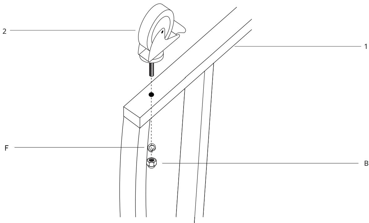
**ÉTAPE 1** - Fixez les quatre roulettes pré-filetées (2 et 3) à chacun des quatre supports (1) en les poussant à travers le trou. À l'aide d'une clé à molette, fixez chaque roue pivotante avec 1x écrou (B).
