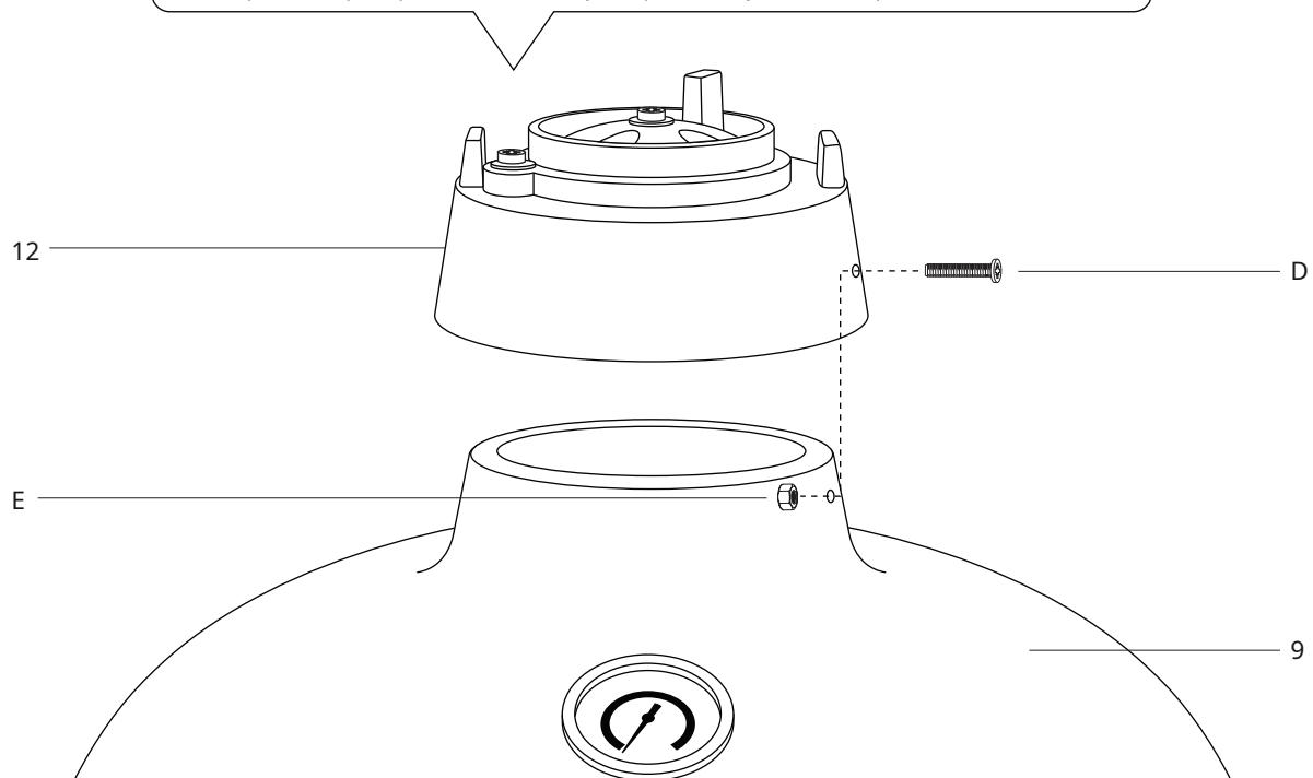
**PASSO 11 -** Para fixar a ventilação superior (12) à Grelha Kamado (9), coloque-a em cima e alinhe os dois orifícios dos parafusos. Seguro usando 2 parafusos (D) e porcas (E). Certifique-se de que o parafuso de ventilação superior esteja no lado esquerdo ao montá-lo.
