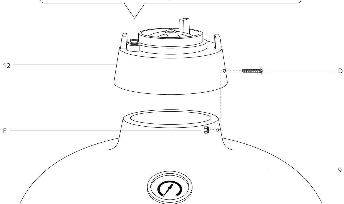
**STEG 11 -**För att fästa den övre ventilen (12) på Kamado Grill (9) placera den ovanpå och rikta in båda bulthålen. Säkra med 2x bultar (D) och muttrar (E). Se till att den övre ventilationsbulten är på vänster sida när du monterar den.
