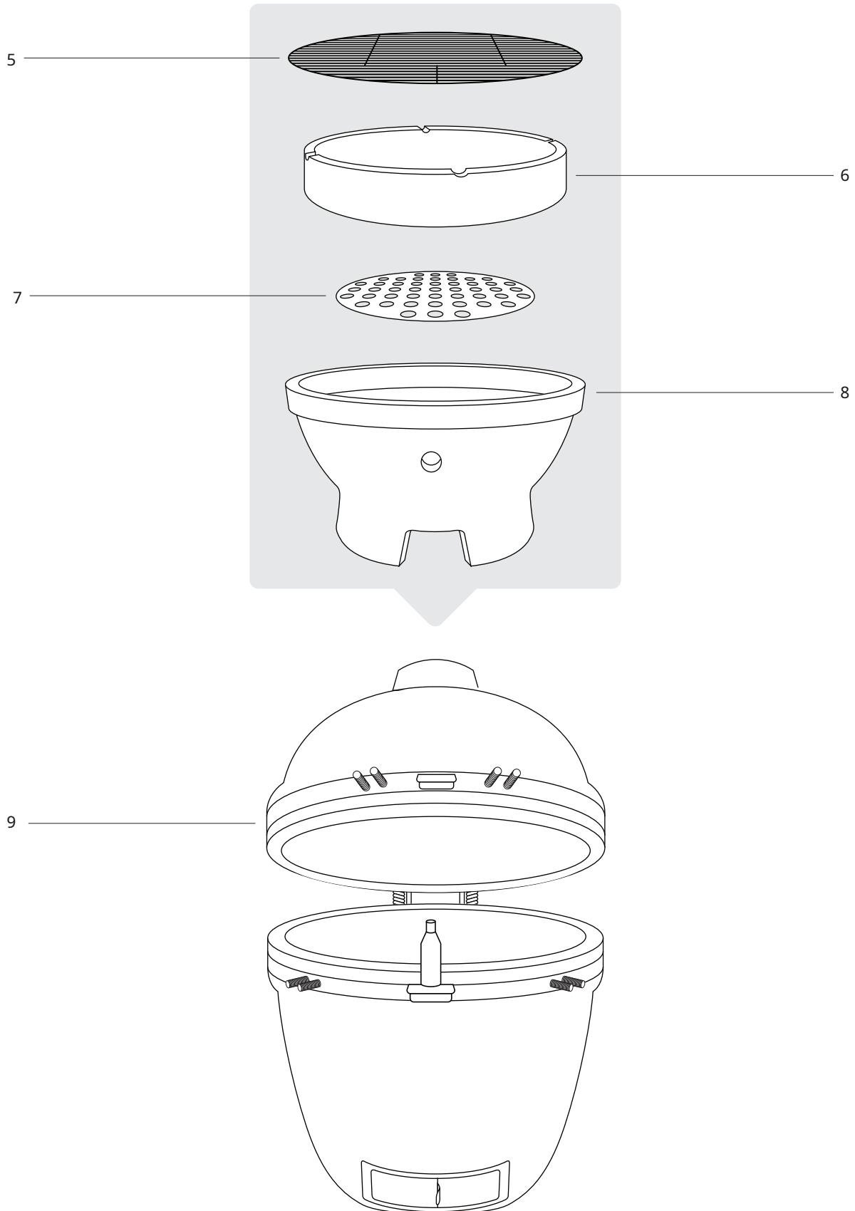
**ÉTAPE 8** -Lorsque le gril est solidement placé sur le chariot, ajoutez le foyer (8), la plaque à charbon (7), l'anneau supérieur (6) et grille de cuisson (5) à l'intérieur du Kamado Grill comme indiqué dans le schéma de montage.
