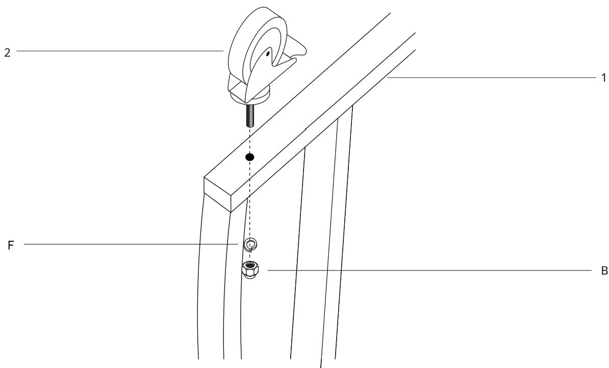
**TRIN 1** -Fastgør de fire for gevindede styrehjul (2 & 3) til hver af de fire beslag (1) ved at skubbe dem gennem hullet. Ved hjælp af en justerbar skruenøgle sikres hvert styrehjul med 1x møtrik (B).
