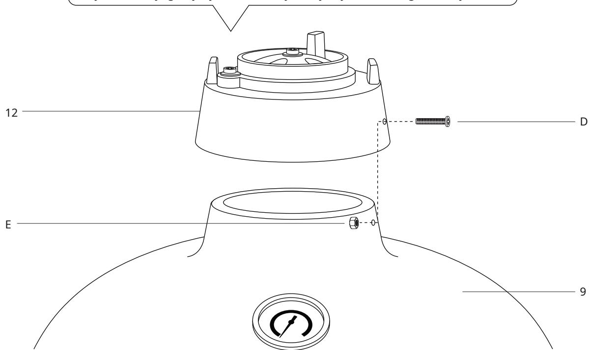
**KORAK 11 -** Za pričvršćivanje gornjeg ventilacijskog otvora (12) na Kamado roštilj (9) postavite ga na vrh i poravnajte obje rupe za vijke. Siguran koristeći 2x vijka (D) i matice (E). Uvjerite se da je gornji vijak za ventilaciju na lijevoj strani kada ga sastavljate.
